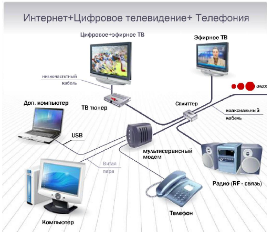
Рисунок 1. Общая схема подключения мультисервисного кабельного модема.
